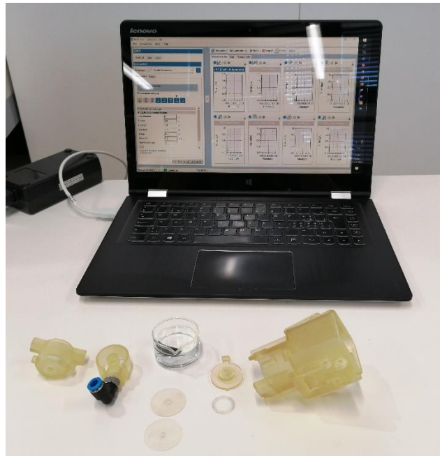
Figure 23 : ordinateur portable connecté au potentiostat, éléments de fixation de la membrane
