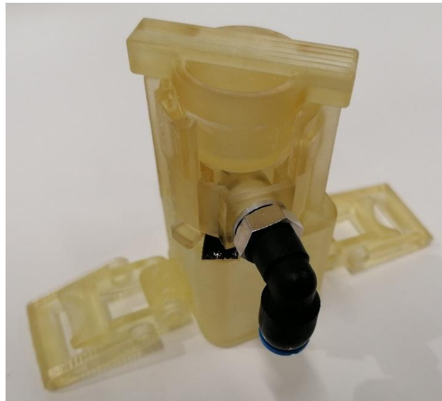
Figure 27 : la membrane dépasse du montage, le bloc d'entrée d'air coude vers le bas
