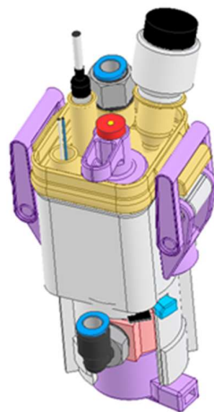
Figure 2: Cellule électrochimique avec, le réservoir d'électrolyte (blanc), le couvercle (jaune), système de fixation (en violet),
