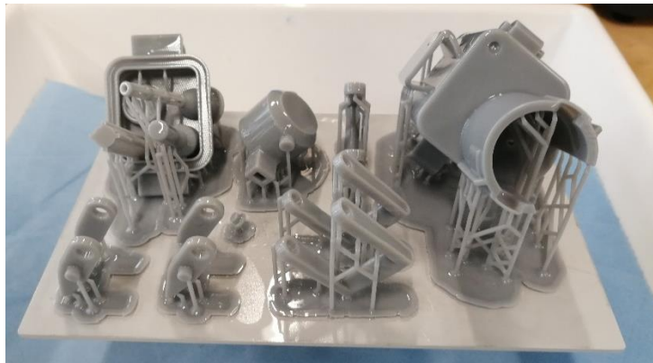
Figure 5 : pièces fraîchement sorties d'impression SLA avec leurs supports d'impression
